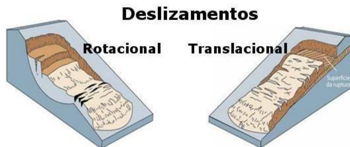
FIGURA 08 - ESQUEMA DE DESLIZAMENTO DE TERRA
